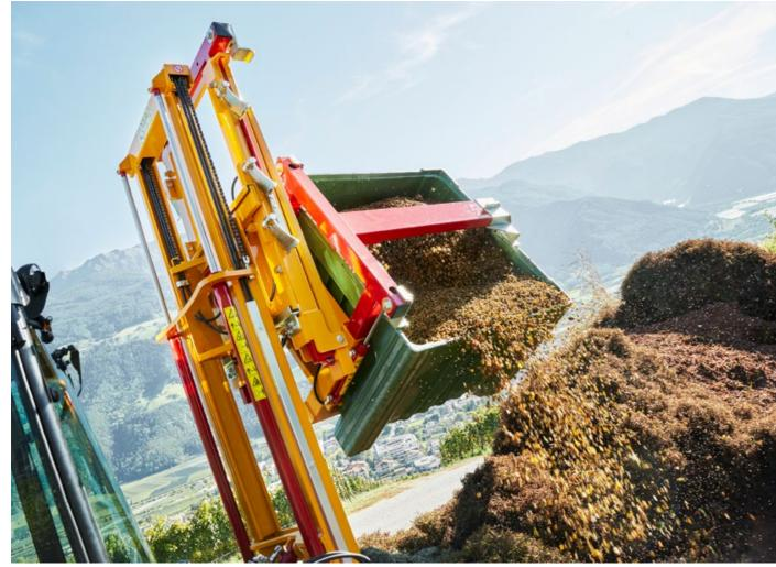
Erst wenn die Kiste sicher geklemmt ist, beginnt automatisch die Drehung. Es wird nur ein doppeltwirkender Anschluss benötigt.
